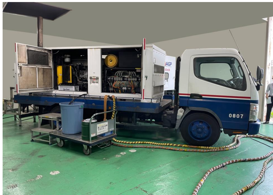
AGP社移動式GPUのバイオ燃料による評価試験の様子
